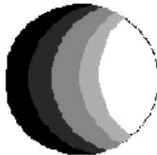
شكل (٤.٣) توزيع التيار في الموصل نتيجة للتأثير السطحي والتأثير التجاوري
